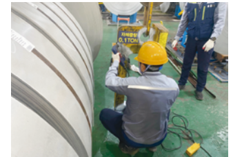
크레인 달기기구 비파괴 검사 (세아제강 창원공장)
